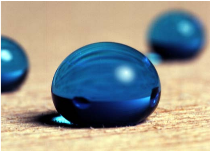
Eine mit Nanostrukturen versehene Holzoberfläche weist Wassertropfen ab.
